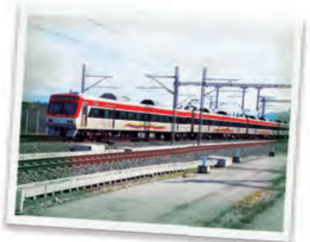
El sistema de suministro eléctrico de un tren recibe el nombre de catenaria.
